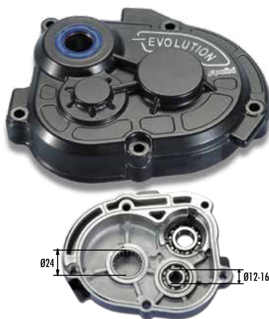
170.0300 Ø12 Piaggio engine for Polini gears with bearings → 2001 Motore Piaggio Ø12 per ingranaggi Polini con cuscinetti → 2001 170.0299 Ø16 Piaggio engine for original gear → 2001 Motore Piaggio Ø16 per ingranaggi originali → 2001
