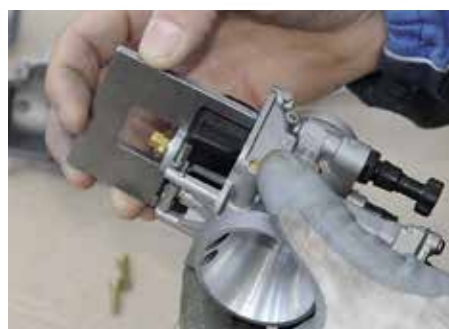
Float level check - Controllo livello galleggiante
